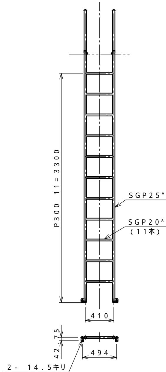
注) SUS304製の場合はSS製と同様の寸法とする。
