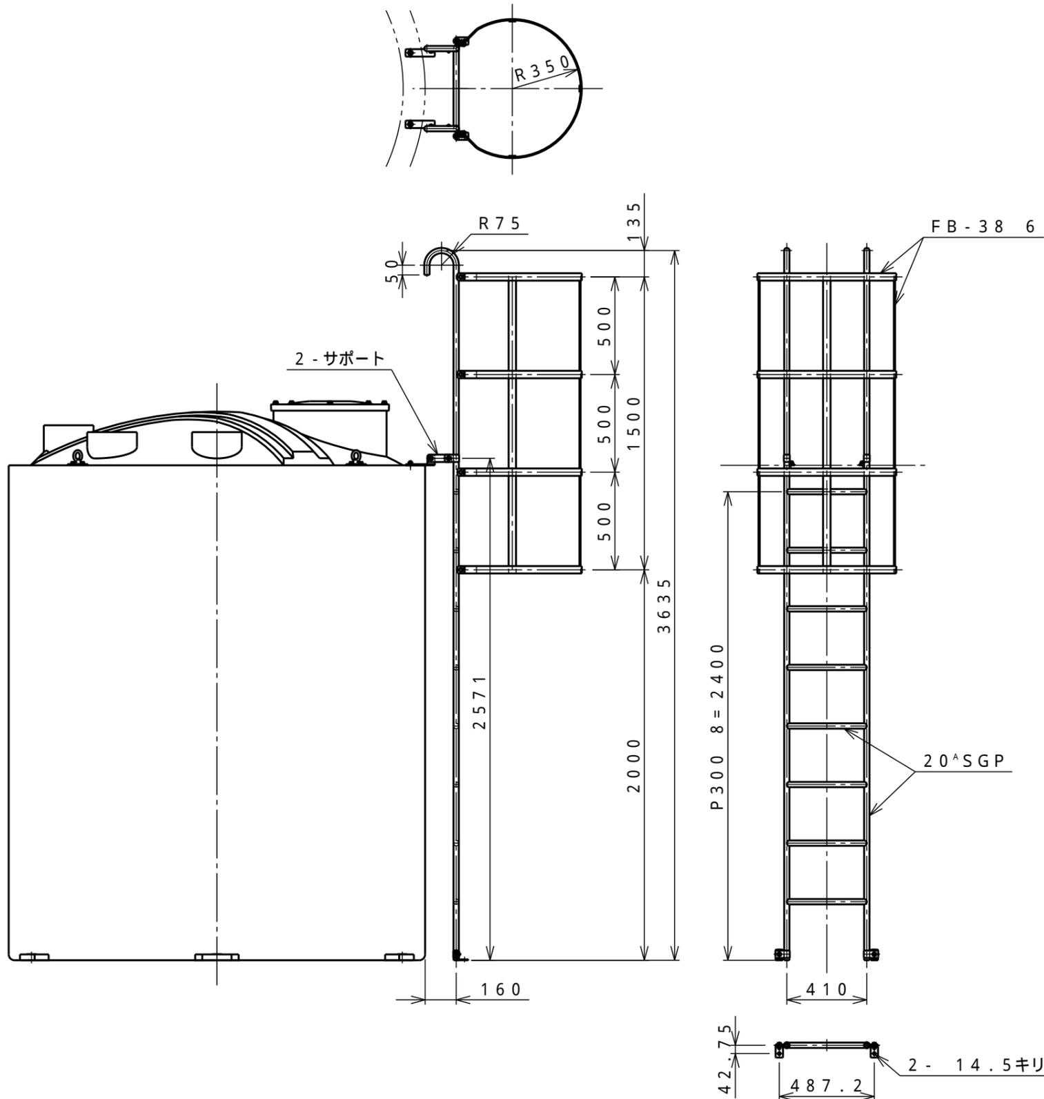
注) SUS304製の場合はSS製と同様の寸法とする。
