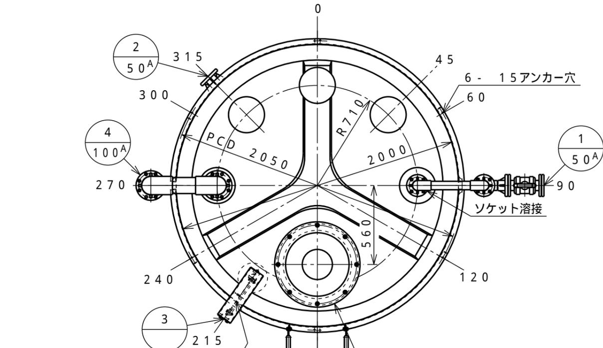
縦補強アングルまたはピース溶接にて取付
