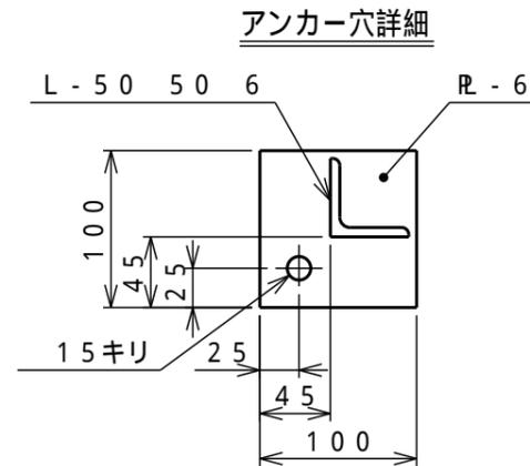
注記) 1. アンカーボルトはM12 (J/L型) を標準とし、ケミカルアンカー使用時はM16を使用する事。
