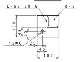
注記)1.アンカーボルトはM12(J/L型)を標準とし、 ケミカルアンカー使用時はM16を使用する事。 (アンカー穴は 19キリ)
