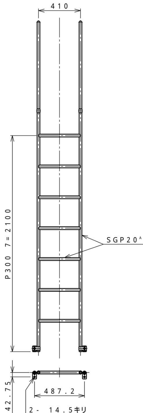
注) SUS304製の場合はSS製と同様の寸法とする。
