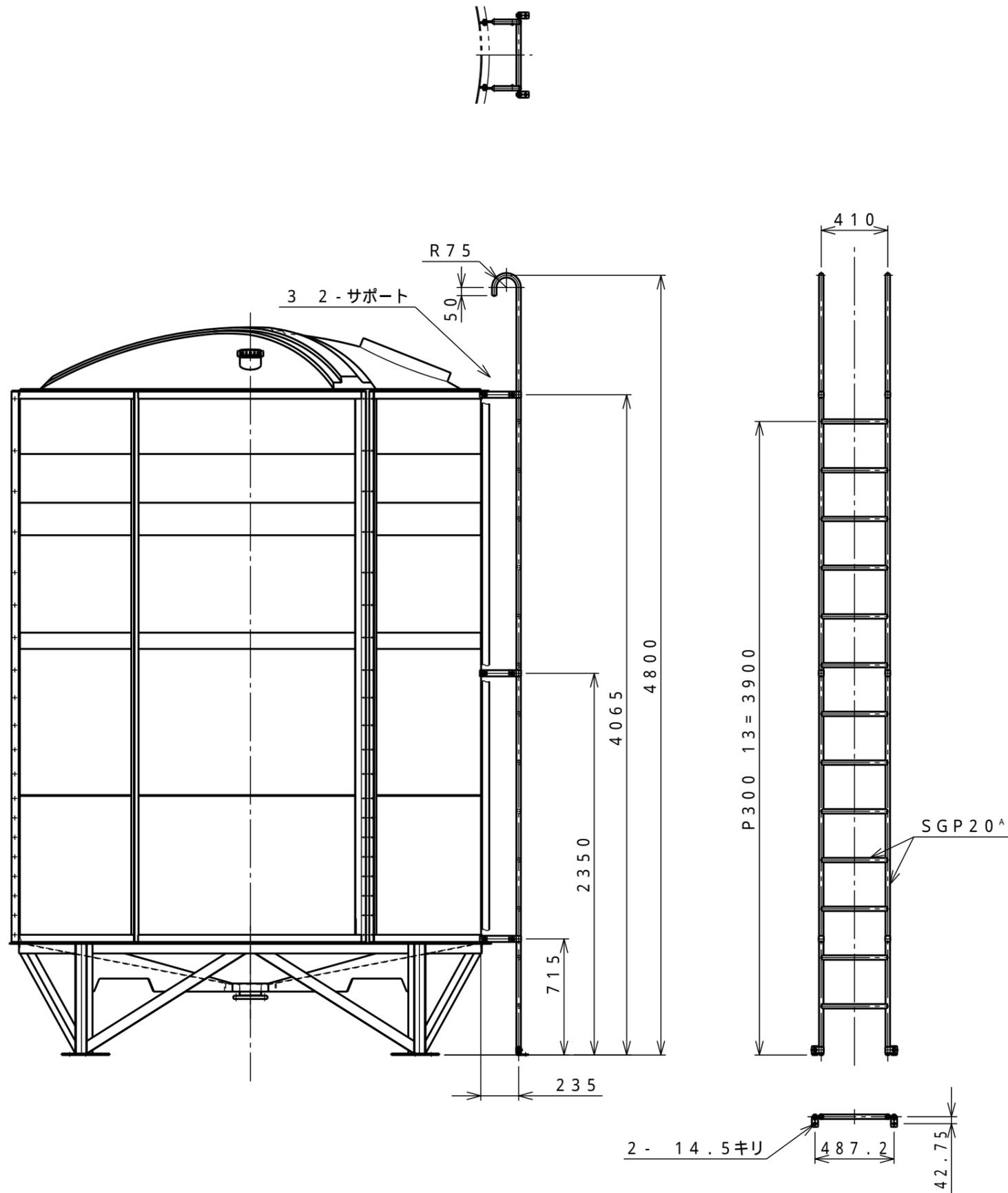
注) SUS304製の場合はSS製と同様の寸法とする。
