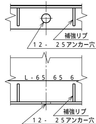
註) 補強リブは、梯子取付ピース等に干渉する部分は削除する事。
