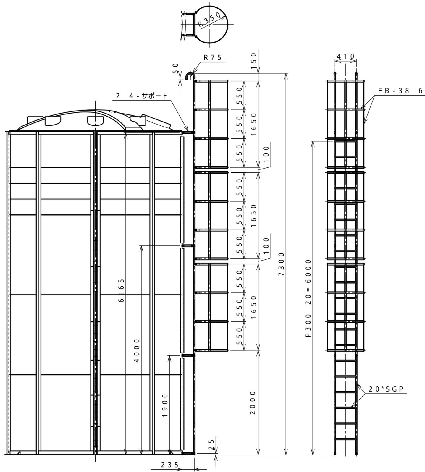
注) SUS 304 製の場合は S S 製と同様の寸法とする。
